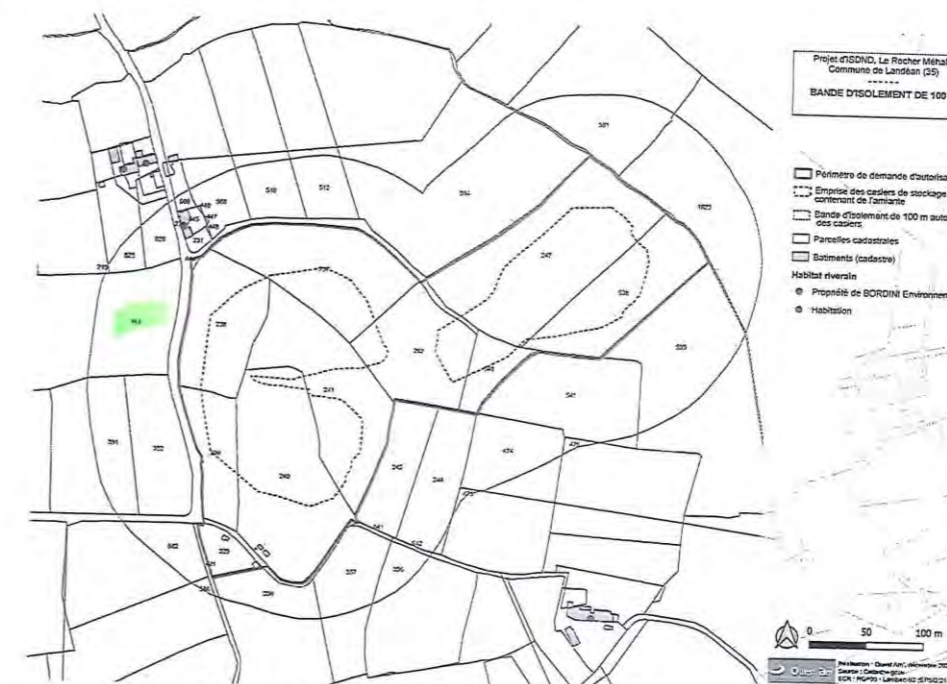
Figure 1 : Bande d'isolement de 100 m autour des casiers de stockage contenant de l'amiante
